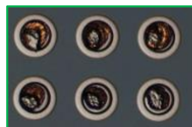
図 2-3.2.3-2 Nb-Nb 接続破断面
