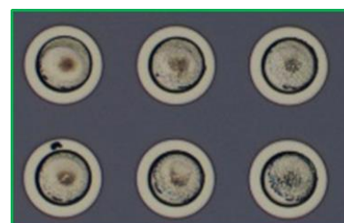
図 2-3.2.3-4 Nb-In 接続破断面
