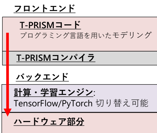
図 2-3.6.2-2 T-PRISM 概要: フロントエンドとバックエンドを分離することでバックエンドに依存しないインターフェースをユーザに提供できる
