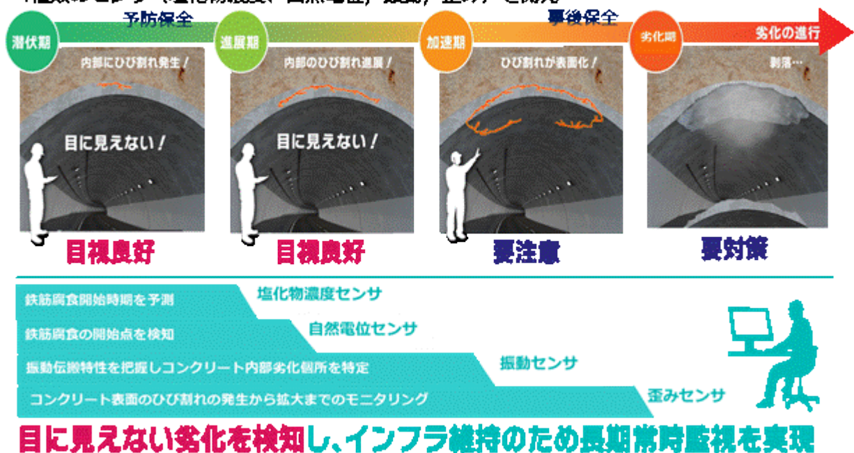
図 3-3.10.4-2 コンクリートの予防保全に寄与するセンサ開発の概要
