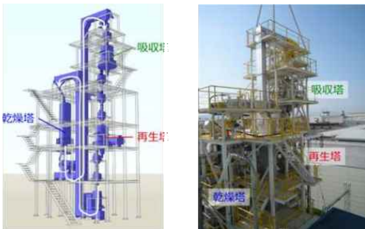
図 3 - 7 移動層ベンチスケール試験装置
