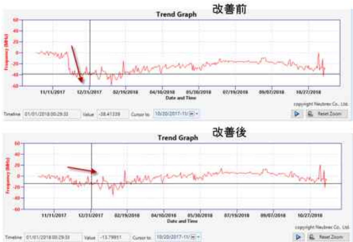
図2.6.3-2 ブリルアン計測での差分計算法の改善前後のトレンド波形
