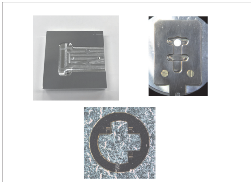
図2. 2. B-1-4 TEMリテーナ用試料ホルダ試作品 (左上: 試料ホルダ、右上: TEMリテーナ、下: 丸マスク)
