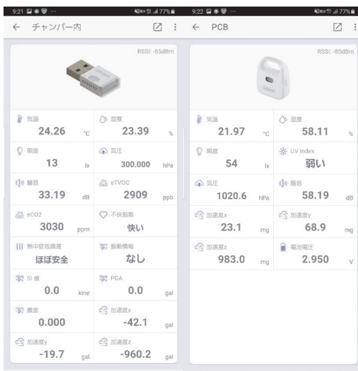
図2. 2. 2-6 センサによる取得データの違い。センサの仕様によって、取得できるデータが異なるとともに、給電方法も異なるので獲得したいデータと装着方法などを勘案してセンサを設置する必要がある。
