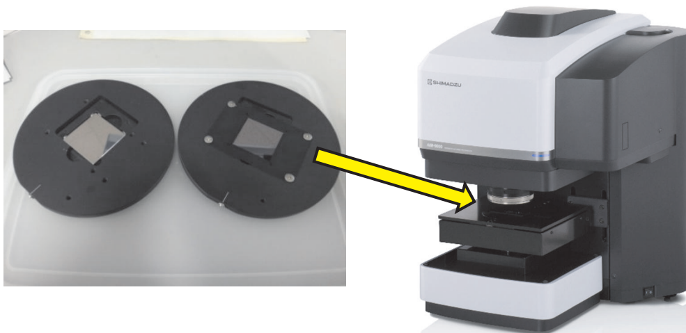
図 2. 2. A-1-2 共通試料ホルダの赤外顕微鏡用アダプタ外観、および AIM-9000 外観
