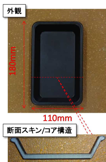
図 III-2.2.1.1- 155 スケールアップ成形品 （トレイ）の外観及び断面
