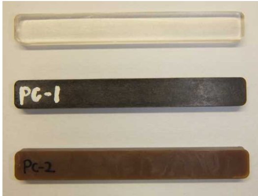
図Ⅲ-2.2.1.1- 65 変性リグノ CNF/PC の射出成形品の外観
