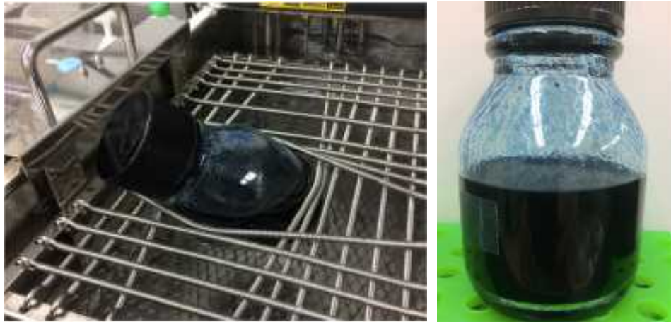
図Ⅲ-2.2.1.2-39 水浴中での反応容器および染色終了後の反応溶液
