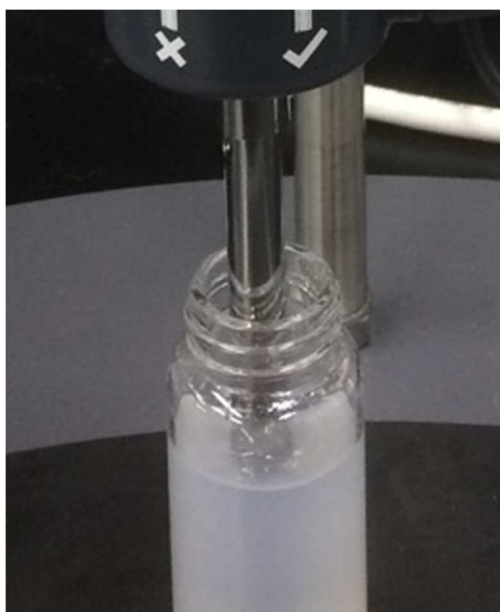
図Ⅲ-2.2.1.2-43 機械攪拌式ミキサーによる CNF の分散
