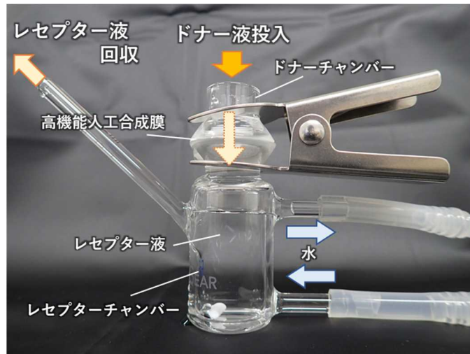
図Ⅲ-2.2.1.2-55 静置型フランツ拡散セルを使った透過性試験装置の概略
