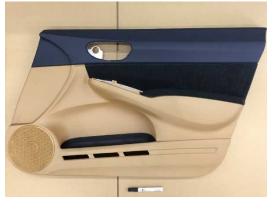
図Ⅲ-2.2.1.1- 188 ドアトリム組立品 (変性リグノ CNF・PP 射出成形)
