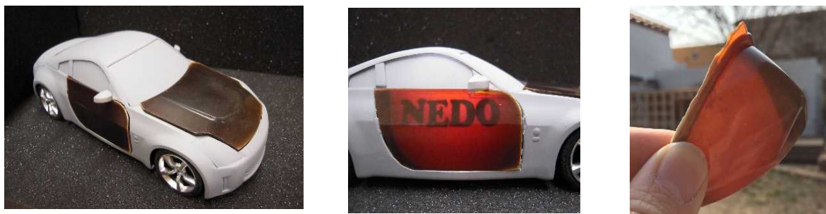
図Ⅲ-2.2.1.1- 27 リグノ CNF を用いた高植物度・高弾性低熱膨張 3次元成形体
