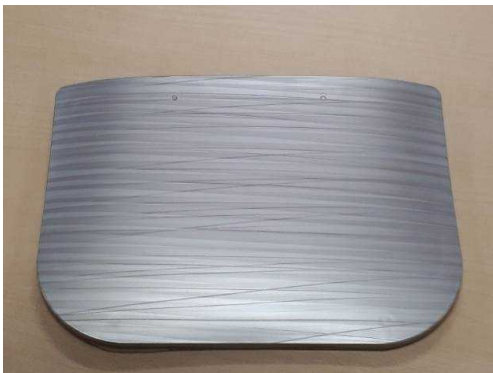
図Ⅲ-2.2.1.1- 189 掃除機カバー (変性リグノ CNF・PP IMD 射出成形)
