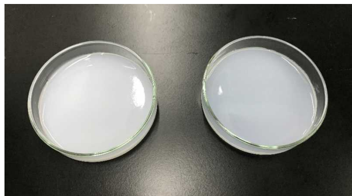
図Ⅲ-2.2.1.3.2.3-6 SK-M-BAQ 由来 1 wt % CNF (WJ 法) の写真 左：斜向衝突法、右：ボール衝突法
