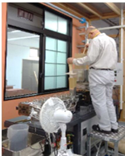
図Ⅲ-2.2.1.3.2.4-62 押出機による混練
