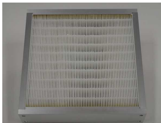
図Ⅲ-2.2.1.3.2.4-41 試作した CNF 含有ナノファイバー不織布ユニットフィルター (サイズ 305 mm×305 mm)
