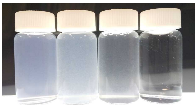
図Ⅲ-2.2.1.3.2.3-23 CNF製造方法による凝集・沈降発生の比較 （KP法タケ）、左からBC法、OC法、En法、TEMPO処理法、 （攪拌後5分静置の0.03% w/v水分散液）
