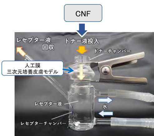
静置型フランツ拡散セルを使った透過性試験装置
