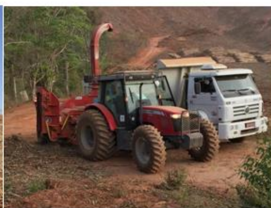
図 2-1-6-1-3 木材破砕機および輸送トラック
