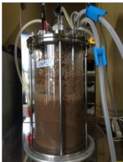
図 2-2-3-3-1 爆砕パルプの糖化の様子 (左上：無処理、右上：180℃、左下：200℃、右下：220℃)
