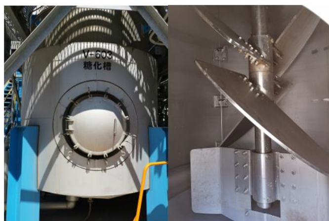
図 2-2-6-3-1 糖化槽外見と Hi-F 攪拌羽
