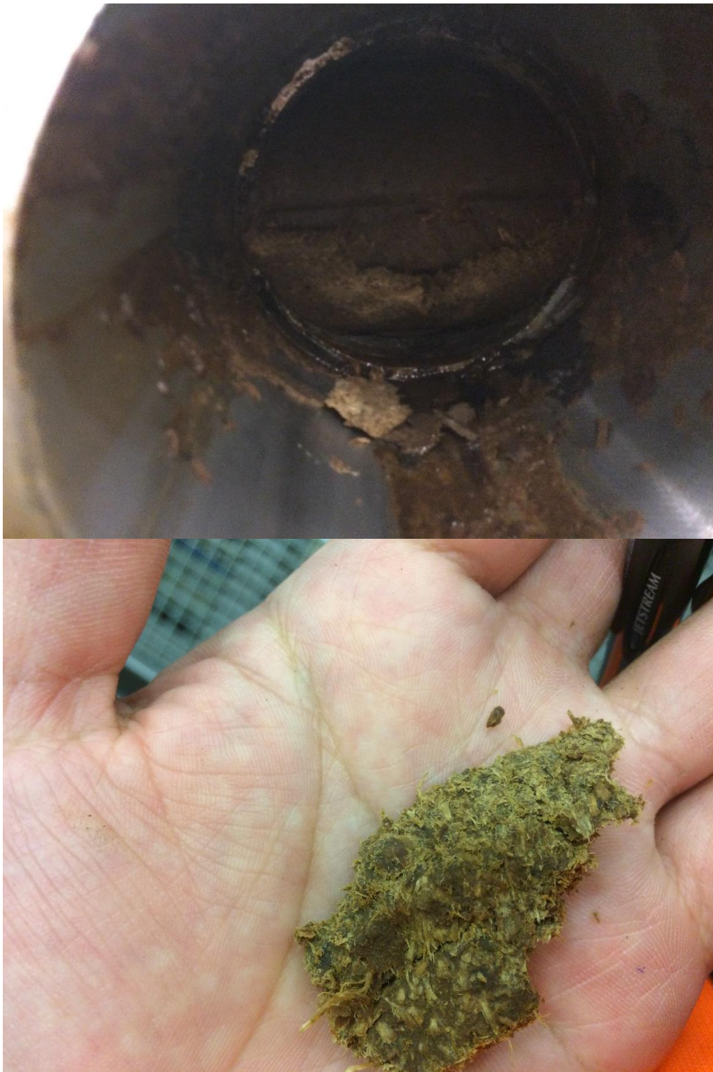
図 2-2-9-3-2 プラグスクリューケーキ形成の様子 良好なシール性が認められる(廃菌床)
