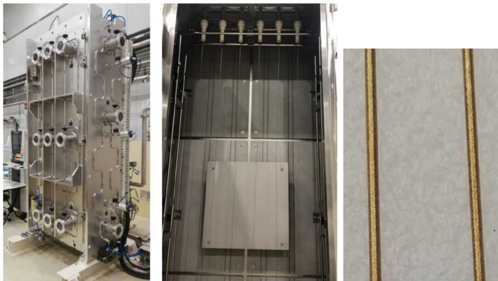
図Ⅲ-2-(二)-C-14 寿命試験に用いたチャンバーの外観（左）、内部（中）、炭化処理後の Ta 触媒体表面（右）
