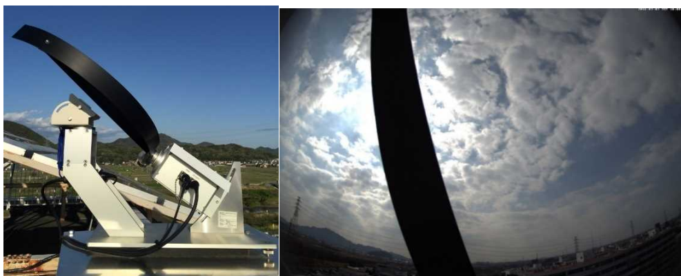
図Ⅲ-2-(ホ)-A-Ⅲ-2 シャドーブレード付き上空カメラの外観(左図)とこのカメラによって捉えられた雲および日射の様子(2016年3月6日10時)
