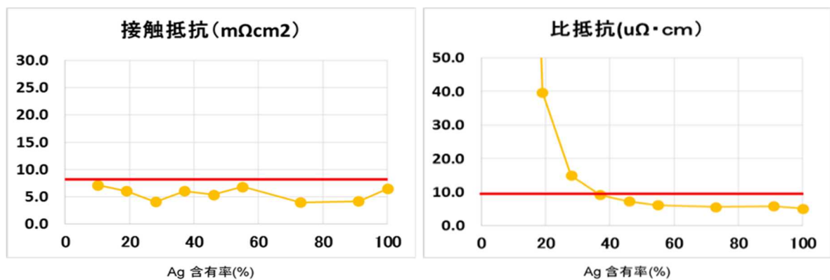
図III-2-(イ)-D-8 Ag コート Cu 粉末+Ag 粉末電極接触抵抗、比抵抗グラフ
