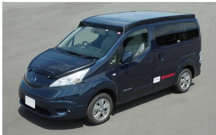
図Ⅲ-2-(ロ)-C-1-b1-6 太陽電池搭載車両外観 (日産 e-NV200)
