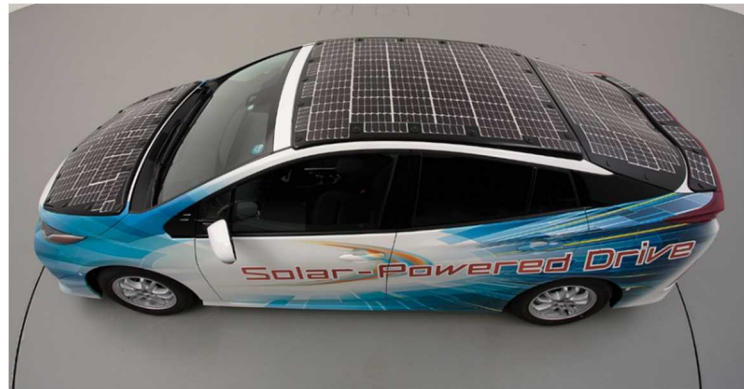
図Ⅲ-2-(ロ)-C-1-b1-5 太陽電池搭載車両外観 (トヨタ プリウス PHV)
