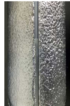
図Ⅲ-2-(イ)-E-6 ドーパントを溶着した 多結晶シリコン棒
