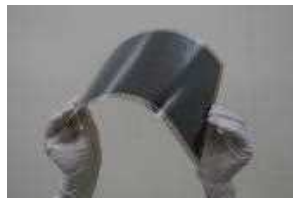
東芝: 世界最大面積のフィルム型 ペロブスカイト太陽電池モジュール (24.15cm × 29.10cm、面積703cm 2 )
