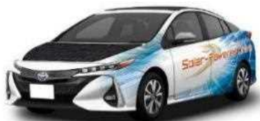
太陽電池モジュールを搭載した「プリウスPHV」
