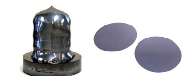
左: 赤外線FZ法により育成されたシリコン単結晶 右: 得られた単結晶より加工したシリコンウェーハ
