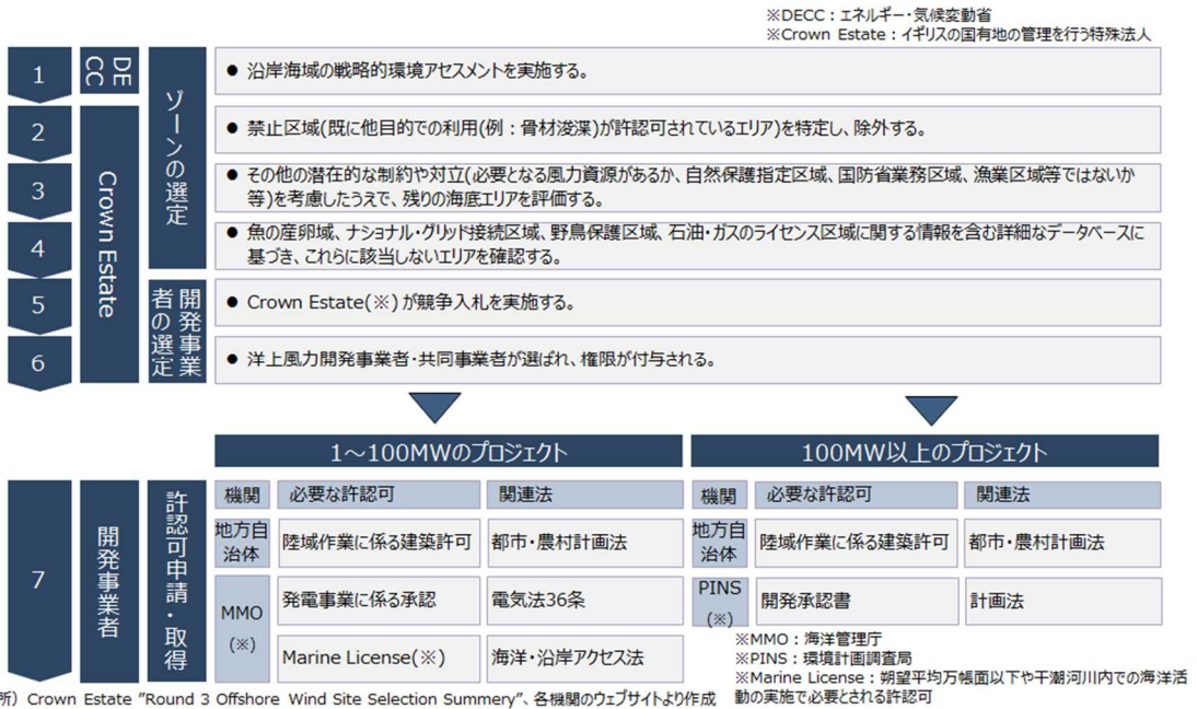
図 3-2-68 イギリスにおける洋上風力発電の許認可取得プロセス
