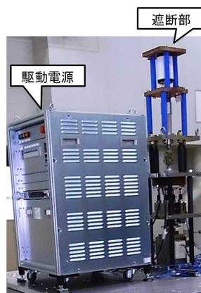
図 3-4-57 遮断部の操作試験概観
