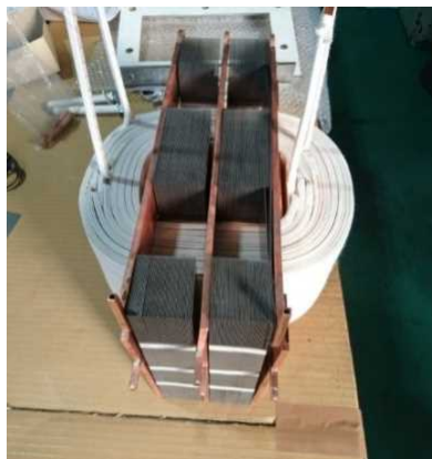
図 3-7-9 水冷高周波変圧器と熱流解析結果 (ポンプ動力 vs. 熱伝達率)
