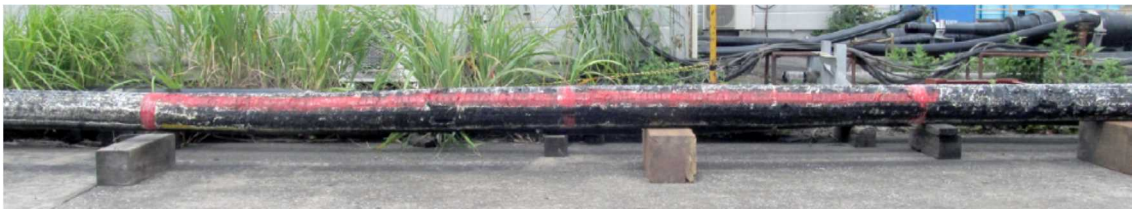
図 3-5-13 長期信頼性評価試験用構造接続部 (鎧層施工後、左 1800mm 2 / 右 2000mm 2 )
