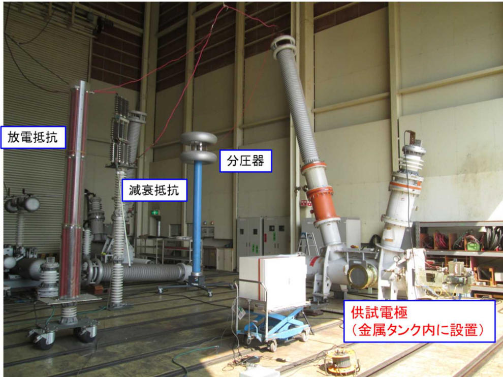
図 3-4-106 消弧後絶縁回復特性の検証実験状況
