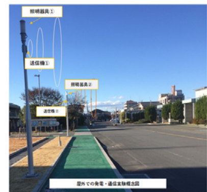
路車間通信の実証試験
