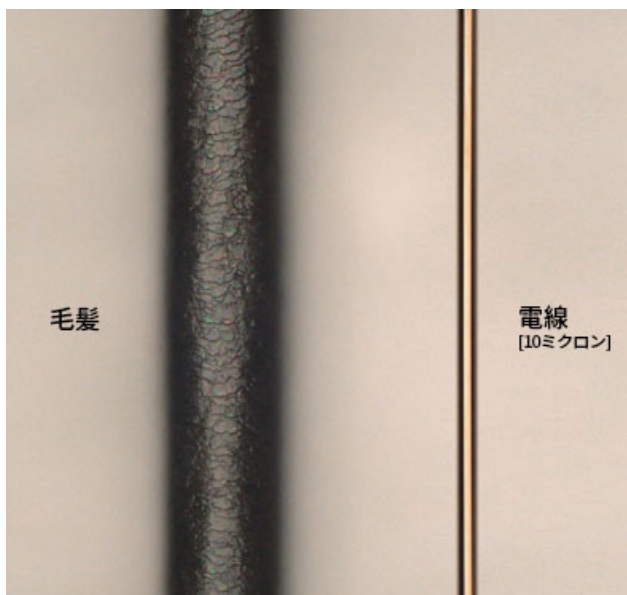
髪の毛よりも細い超極細MgB 2 超電導素線 （イメージ）
