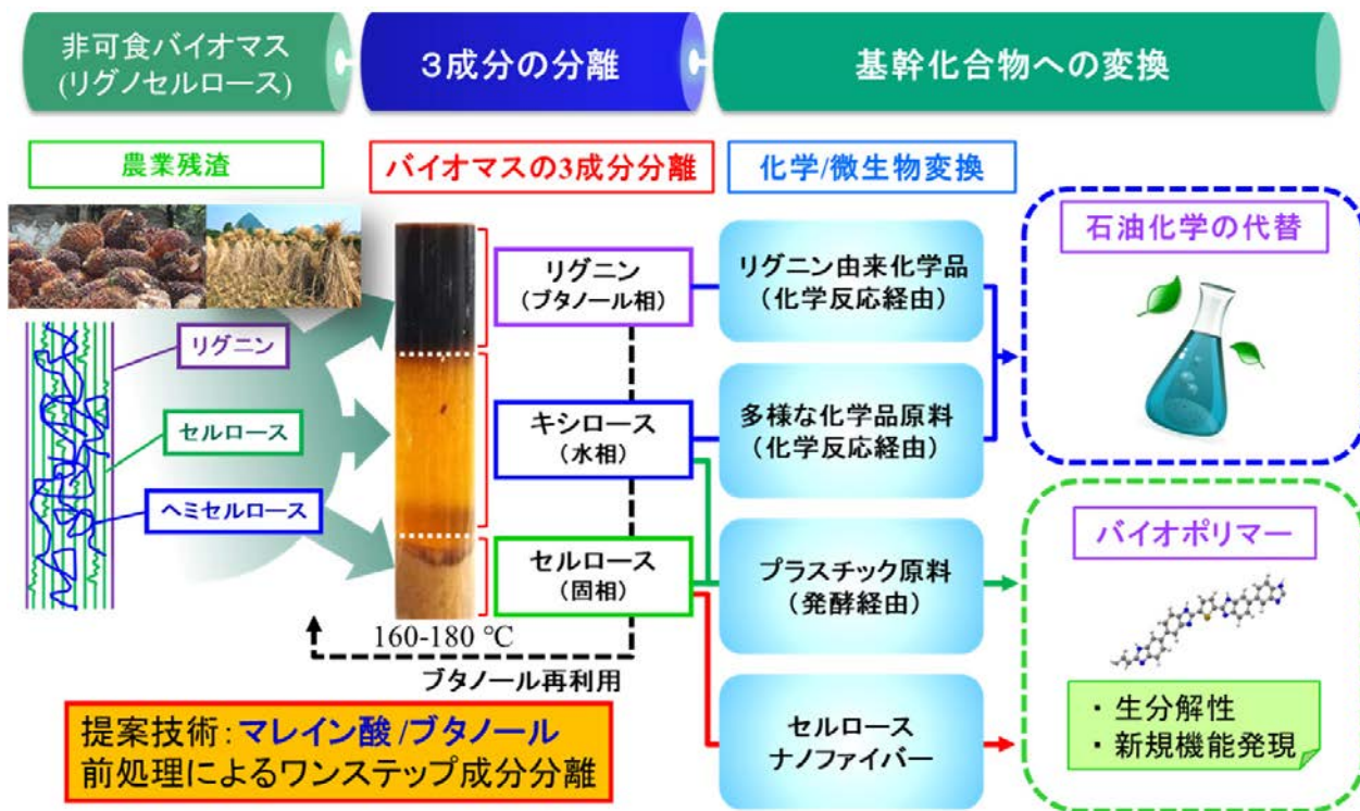
図 リグノセルロースバイオマスのワンステップ3成分分離と化学/生物変換
