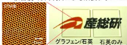
石英基板上に500度で直接成膜した単層グラフェン
