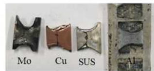
各素材毎の溶損状況
