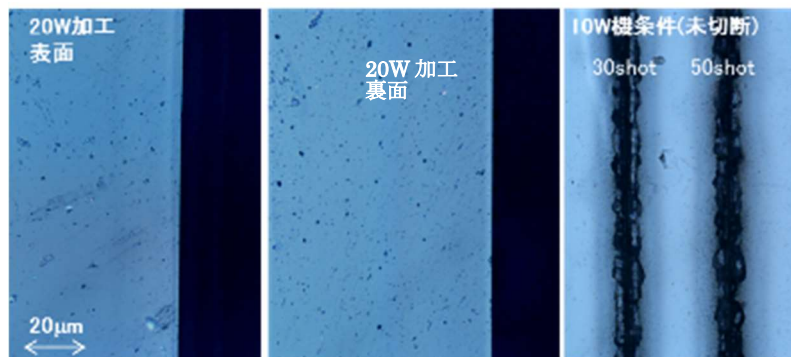
図Ⅲ2-1-3-9 20W 加工機を用いた高品位加工実証例
