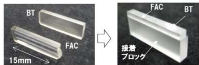
図Ⅲ2-5-1-9 400nm 帯用光学素子の構成
