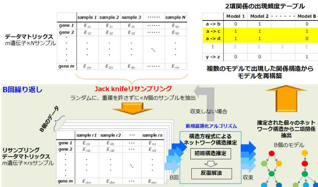
図 3.2.3.2-3-14 少数データからのネットワーク構造推定手法
