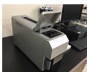
図 3.2.3.1-5-6 蛍光相関分光装置と SI トレーサブルな標準試料で校正した装置による RNA 数の測定
