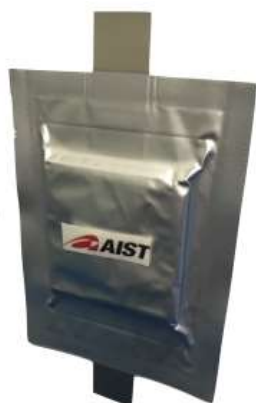
図 3.1-2-5 コンバージョ ン電池 実セルの外観
