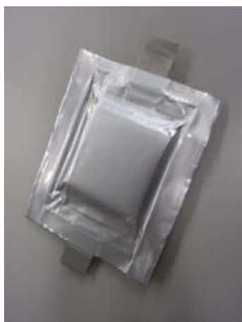
図 3.1-2-7 硫化物電池 実セルの外観
