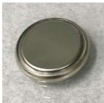
図 3.1-2-1 ハロゲン化物電池 実セルの外観
