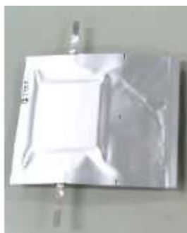
図 3.2-2-21 硫化物電池 実セルの外観
