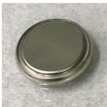
図3.2-2-1 ハロゲン化物電池 実セルの外観
