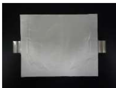
図 3.2-2-15 コンバージョン電池 実セルの外観
