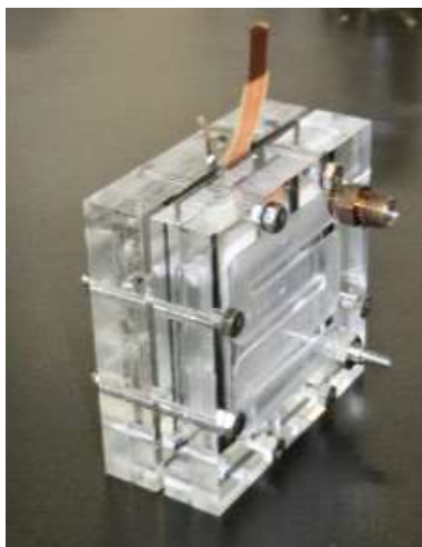
図 3.1-2-3 亜鉛-空気電池 実セルの外観
