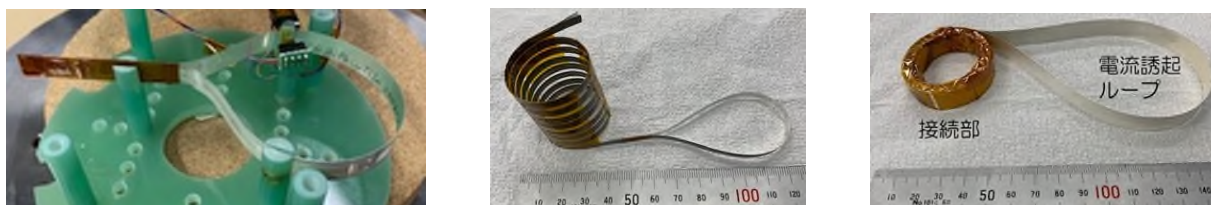
図 2.3.6-4 接続抵抗を測定した試料の例 (左から順に、接続面積が大きくなっている)
