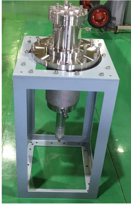
図 2.1.2-7 液体窒素循環ポンプの外観
