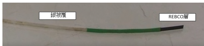
図 2.3.6-33 銅安定化層および銀保護層を除去した REBCO 高温超電導線材
