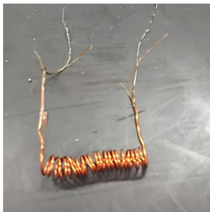
図 2.3.6-41 NbTi 製永久電流スイッチ
