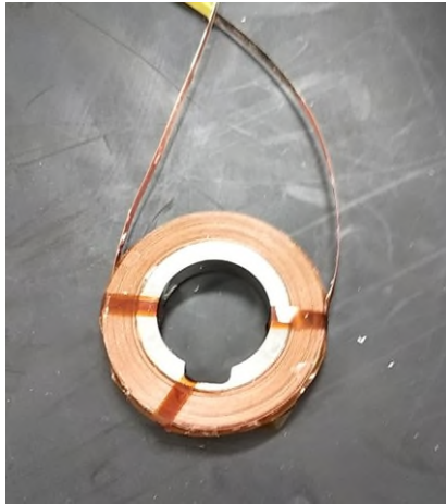
図 2.3.6-40 製作した REBCO 高温超電導試験コイル
