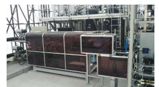
世界初炭化水素膜による PEM型水電解装置
