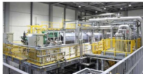
世界最大の水電解スタック（10MW）
