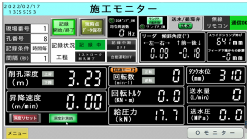
施工管理装置画面例
