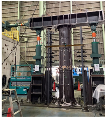
1/10試験体による交番载荷実験及びFEM (2020年度)
