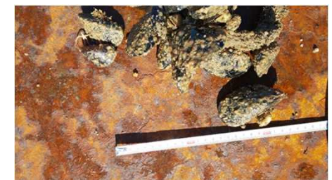
波浪ブイ係留ラインへの付着生物
