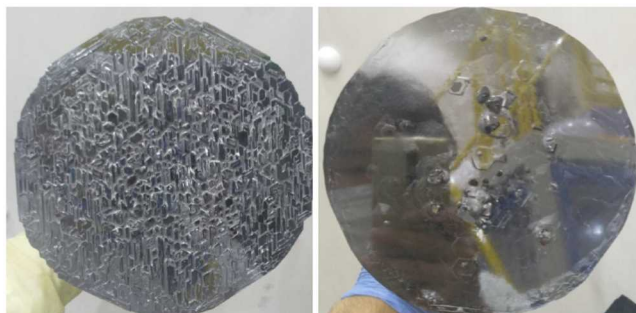
図3 (左) 従来 (右) 最適化された実験条件を用いて育成した SiC 結晶
