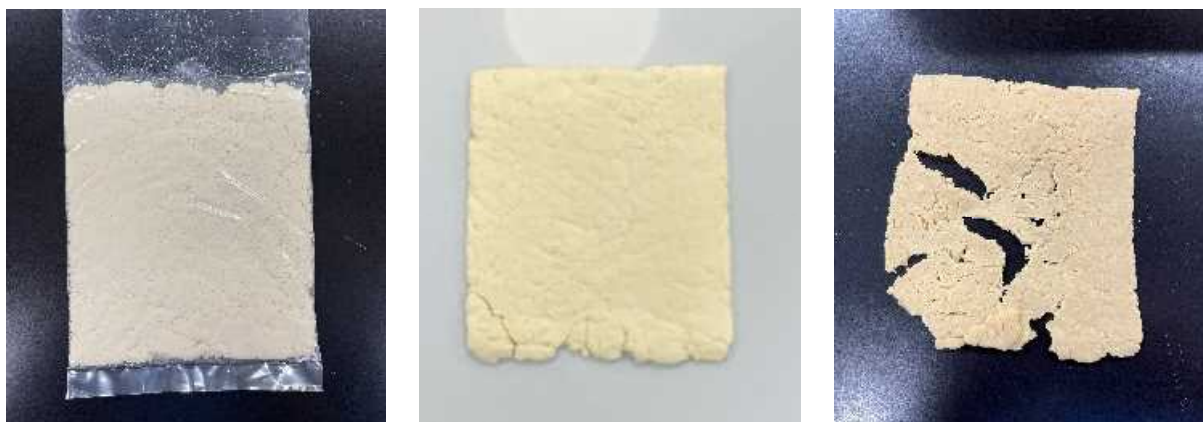
図Ⅲ-2.2.1.6-2 シート化工程における固形物の様子
