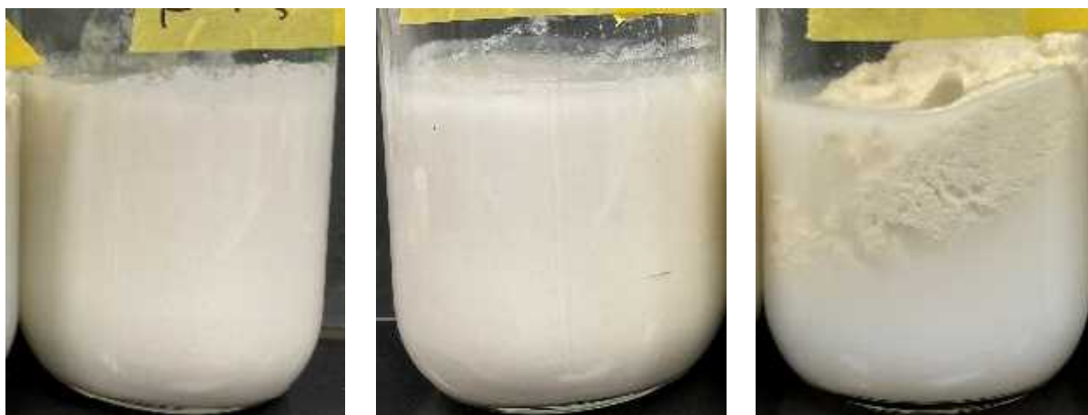
図Ⅲ-2.2.1.6-1 異なる攪拌強度で混合した複合液（左から Run1、2、3）
