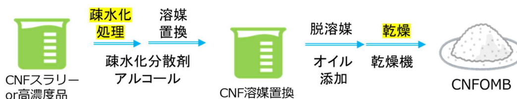
図Ⅲ-2.2.1.5- 10 OMB 製造工程図
