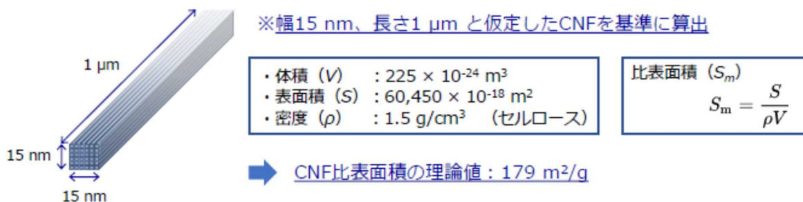
図III-2.1.5-6 CNF化率の算出方法
