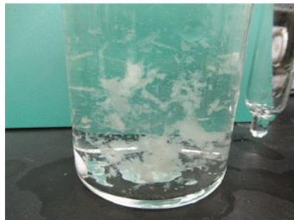
写真Ⅲ-2.1.2-1 ラボ BOD 試験中に発生する微生物フロック
