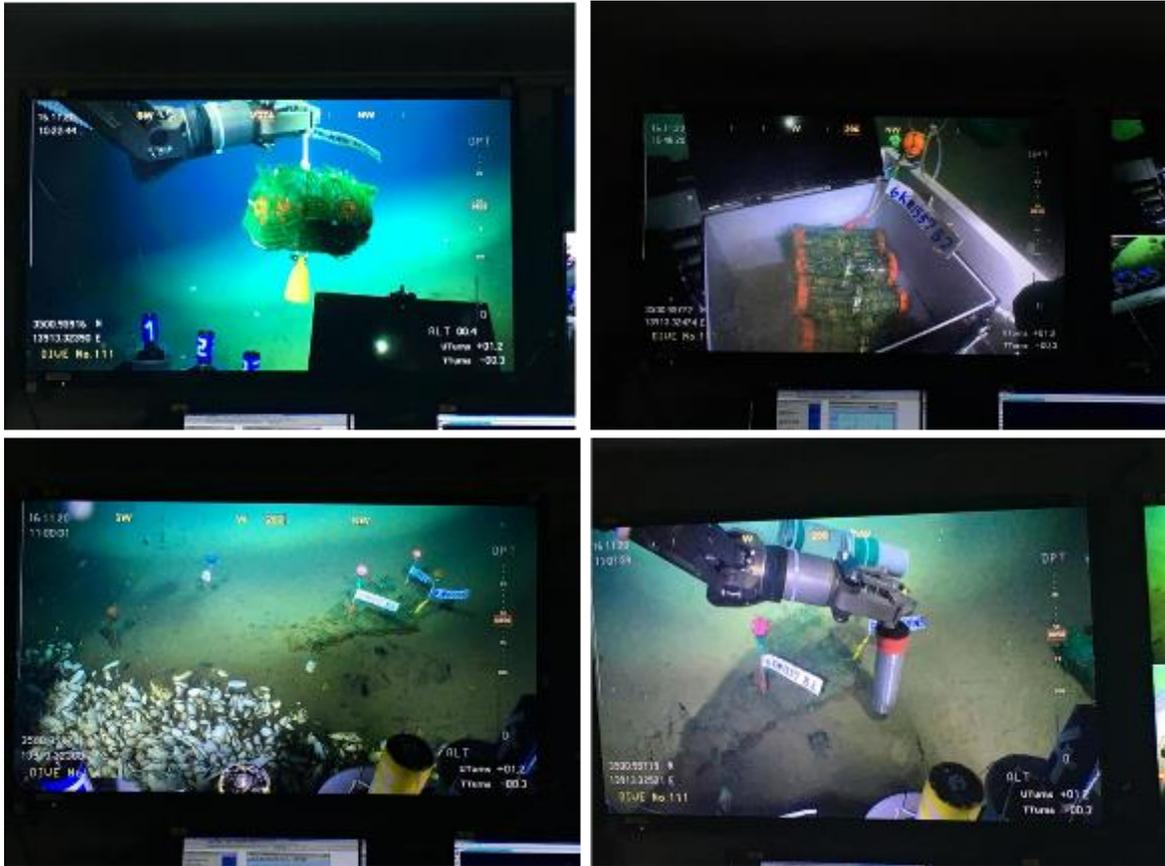
図Ⅲ-2.1.11-4 しんかい 6500（有人潜水艇）のマニピレーター（ロボットアーム）を用いたサンプルおよび海底土の設置・回収の様子
