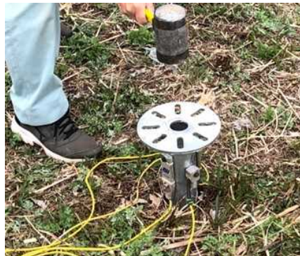
図Ⅲ-2-(ロ)-(i)-D-7 衝撃載荷試験状況 (PDA)
