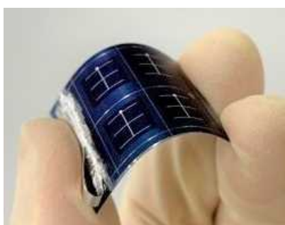
図. III-2-(イ)-(iii)-C-1 厚さ0.1mmの可撓性金属薄板上に作製したCIS太陽電池の外観
