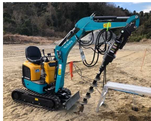
図Ⅲ-2-(ロ)-(i)-D-2 掘削穴を施工するための専用マシン
