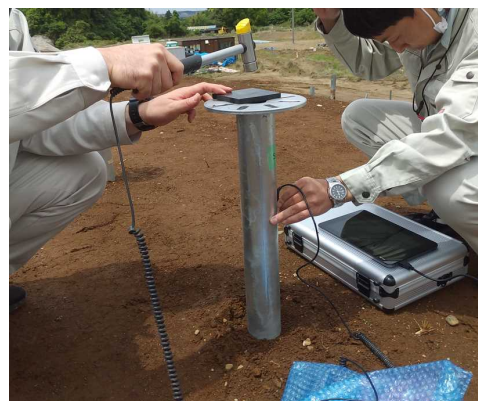
図Ⅲ-2-(ロ)-(i)-C-2 杭の支持力簡易診断装置（左） 杭の支持力間診断の様子（右）
