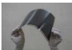
東芝: 世界最大面積のフィルム型 ペロブスカイト太陽電池モジュール (24.15cm × 29.10cm、面積703cm 2 )
