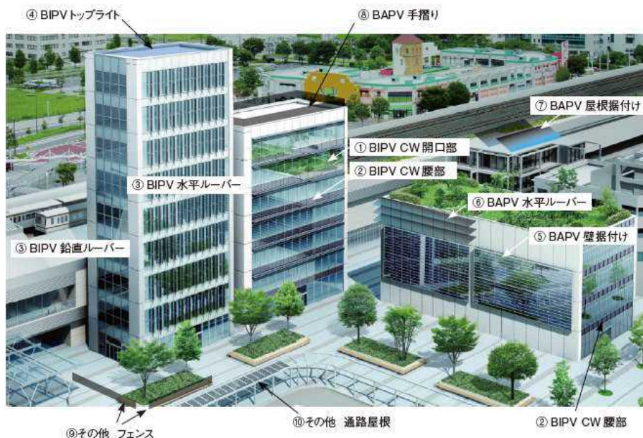
図Ⅲ-2-(イ)-(ii)-I-1 建築物とPVが融合した様々な例。 (2016年度NEDO「BIPVに関する調査・検討」報告書より)
