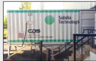
Solidia Technology社のCO 2 養生設備 2
