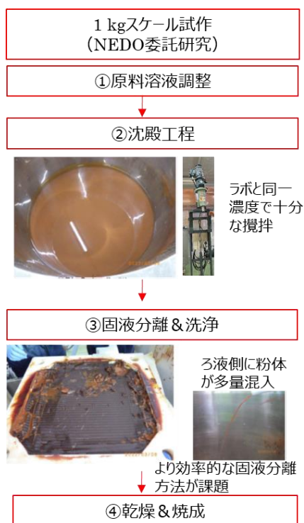
図 3.2-1 1kg スケールの触媒試作工程
