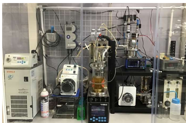
図 3.2.2.3-1 ラボ酢酸発酵装置
