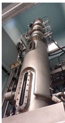
図 3.2.2.3-5 酢酸発酵ドラフトチューブ付き気泡塔
