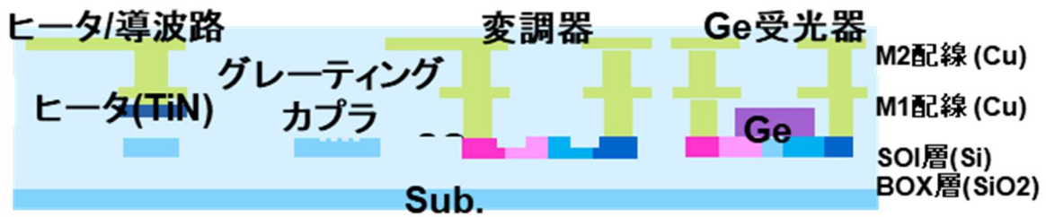
図 1.2.2.1(イ)-8 ファンドリにおいて試作した光集積回路の断面構造
