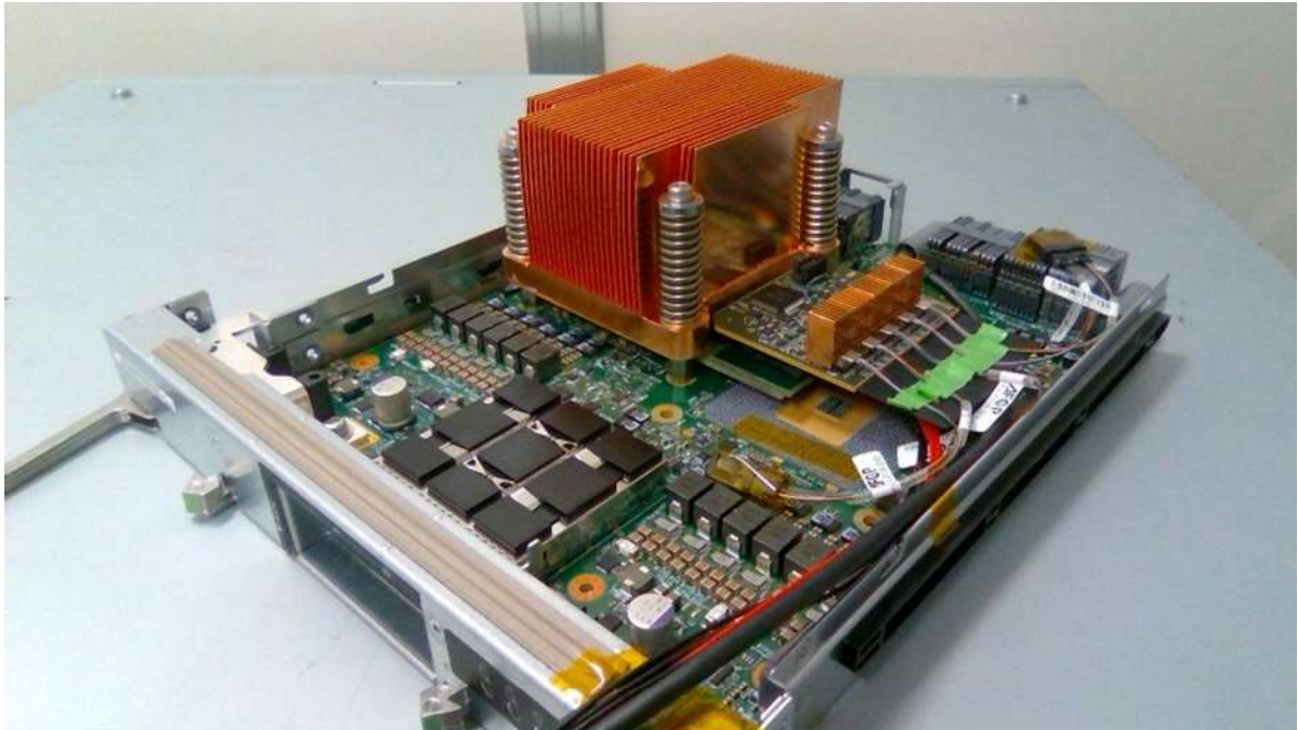
図 1.2.2.2(エ)①- 50 試作した光電子融合サーバボードプロトタイプの外観
