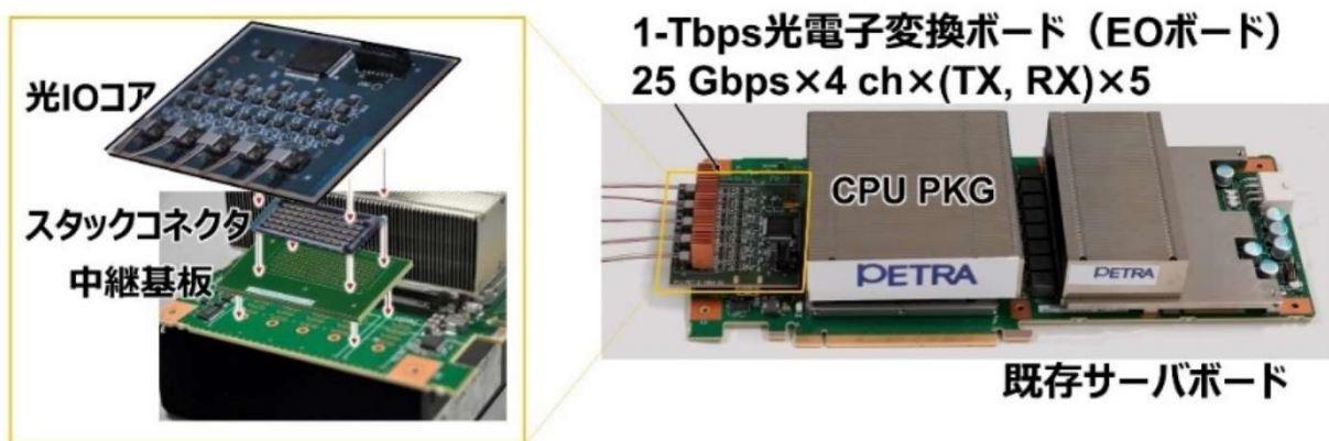
図 1.2.2.2(エ)①- 38 試作した EO ボードと既存サーバボードへの実装
