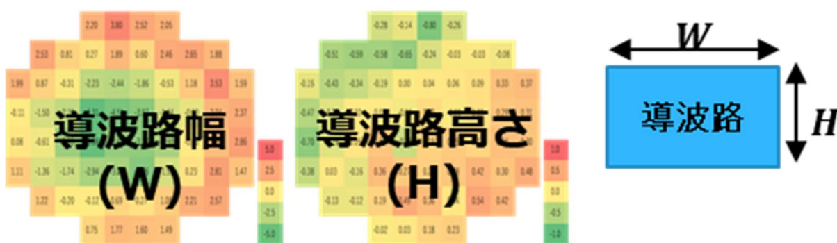
図 1.2.2.1(イ)-19 導波路加工モニタ回路の TE モード及び TM モードの共振波長ばらつきから抽出された導波路幅と導波路高さの偏差の 300 mm 径のウェーハ面内の分布
