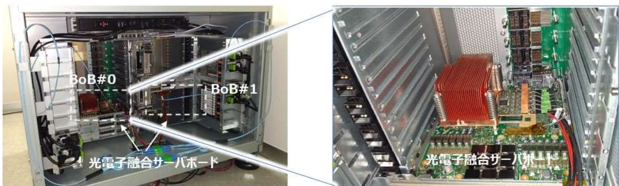
図 1.2.2.2(エ)①- 52 光電子融合サーバボードを搭載した評価用サーバシステム外観（左）とその拡大写真（右）
