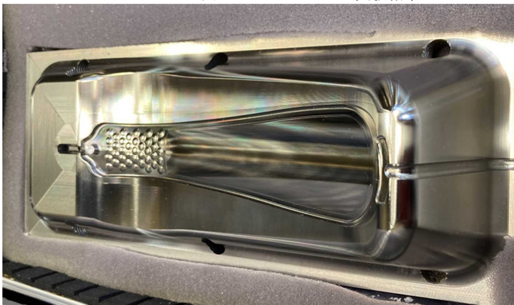
図 2-13-46. 金型加工実験結果 2（意匠面あり）
