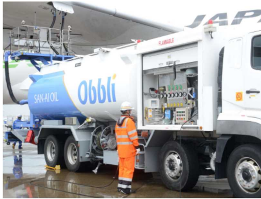
写真 1.3.7.2-2 給油車からの給油
