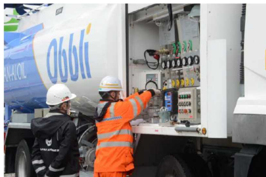
写真 1.3.7.2-1 給油前の点検
