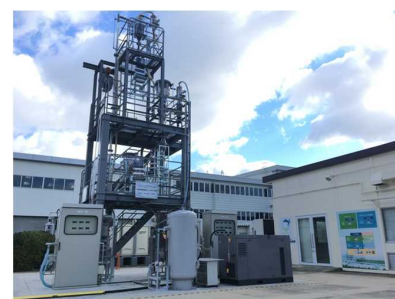
写真：大阪ガス(株)「Carbon Neutral Research Hub」の見学ルートに入っているケミカルルーピング大型コールドモデル
