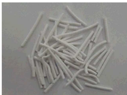
Ⅲ.2.2.5.2.1-1 成形したMTO反応用ゼオライト触媒
