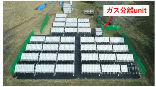
100m 2 スケールでの屋外試験での光触媒シートのスケールアップ容易性の実証
