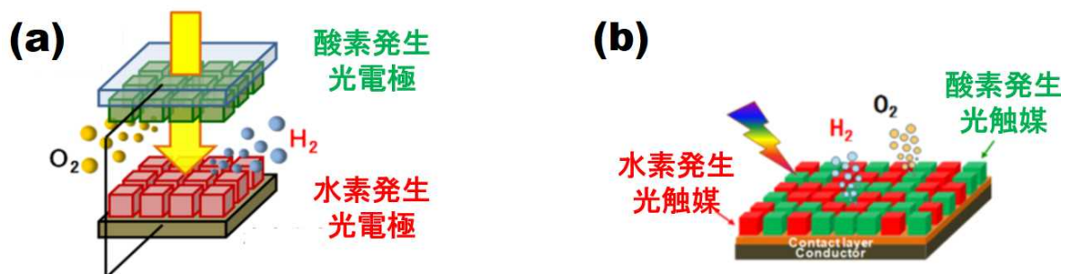
図Ⅲ. 2-1-1-8-2. (a) タンデム型2電極セル、および、(b) 混合粉末型光触媒シートの模式図
