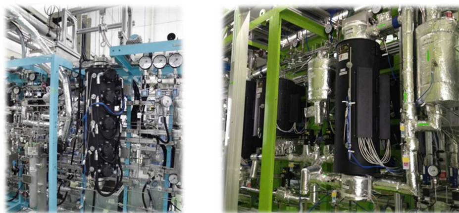
図Ⅲ.2.2.5.1-1 2016 年度に検討した小型パイロットプラントの外観 (左：メタノール合成小型パイロット、右：MTO 小型パイロット)
