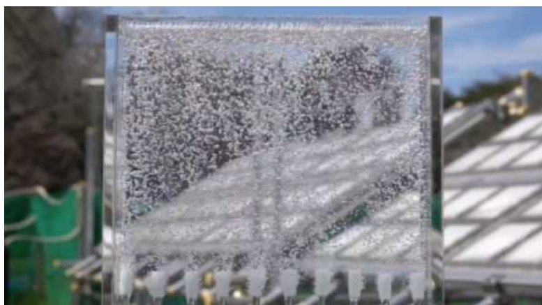
図Ⅲ. 2-1-1-12-10. 100m 2 規模の光触媒パネル反応器から生成した水素と酸素の混合気体
