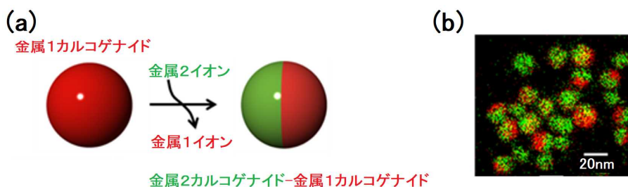
図Ⅲ.2.1.1.3.1-6 金属1カルコゲナイドおよび金属2カルコゲナイドからなるヘテロ構造ナノ粒子の(a)合成スキーム、(b)STEM-EDS元素マッピング像
