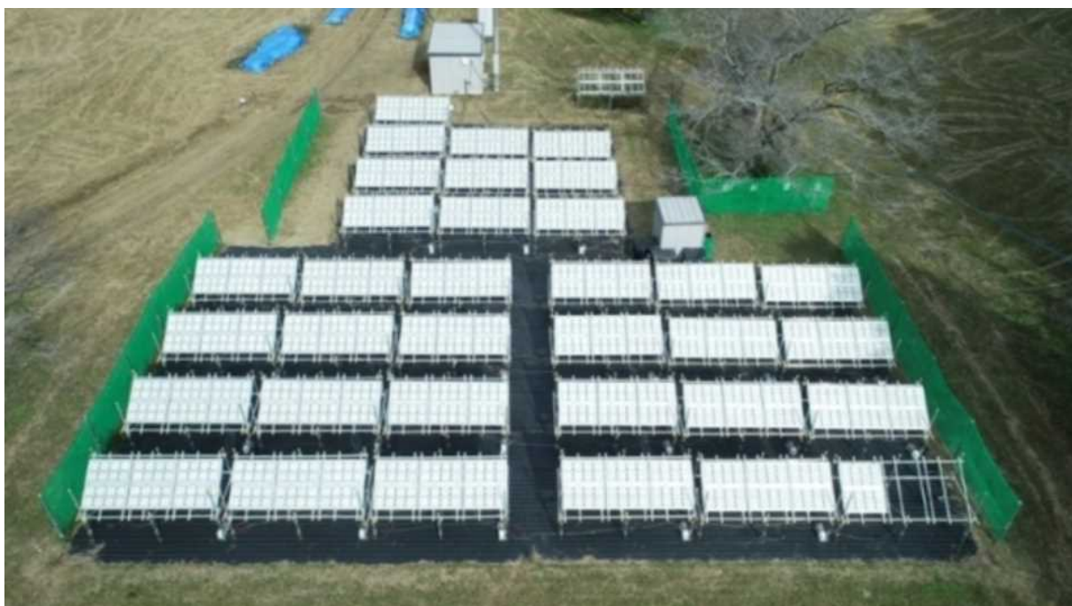
図Ⅲ. 2-1-1-12-9. 100m 2 規模の光触媒パネル反応器の外観
