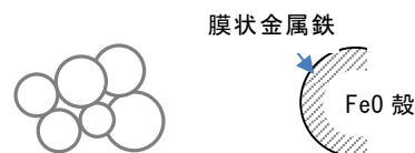
図①-4-1.1 流動層還元過程における流動化不能現象の原因としての生成金属鉄形態 1)
