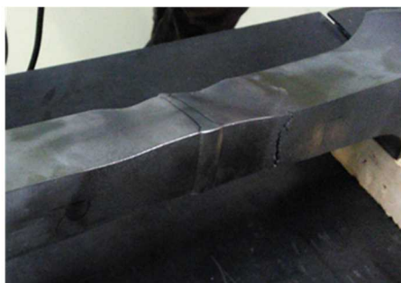
図 3.2- 2 損傷した短冊一軸クリープ試験体
