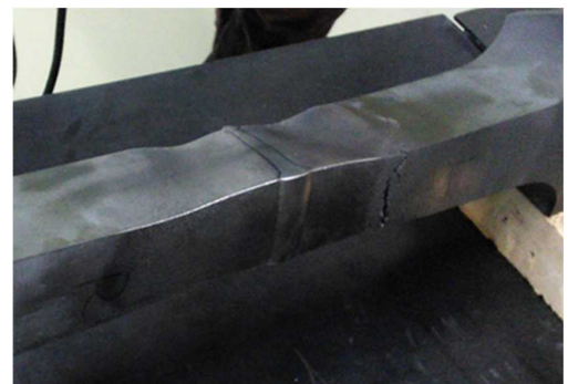
損傷した短冊一軸クリープ試験体
