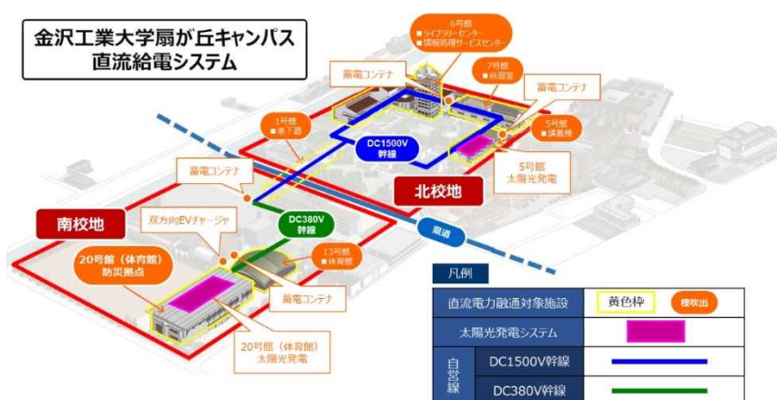
図 10 LVDC に関する実証の例(380V と 1500V の LVDC ネットワーク)
