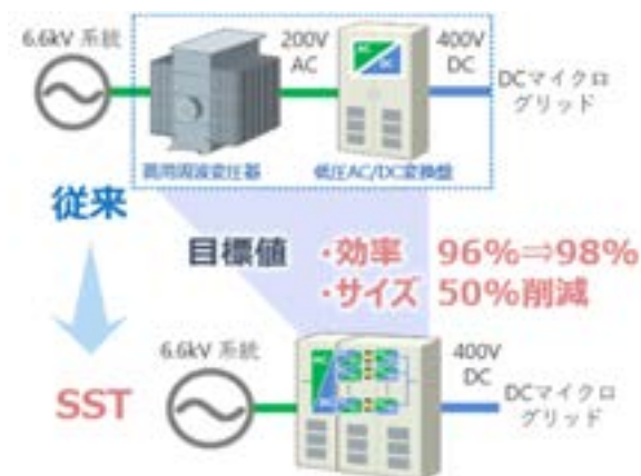
図2 スマートSSTによる高パワー密度化, 高効率化の実現
