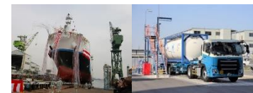
国際間の大規模水素サプライチェーン実証 (左) 液水運搬船、(右) MCHタンクコンテナ
