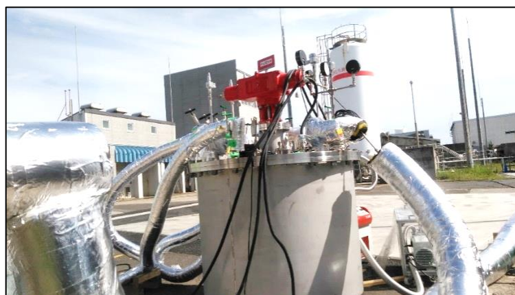
図 2. 原理試作品による LH 2 実液試験の様子
