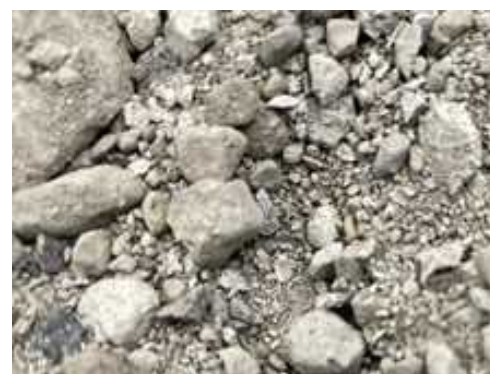
廃コンクリートを粉砕
