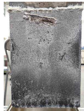
図 4-1-16 電解後カソード表面 (アルミ展伸材)
