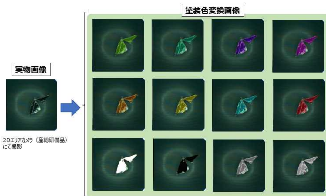
図 4.3.14 塗装色変換による 2D 画像データ拡充
