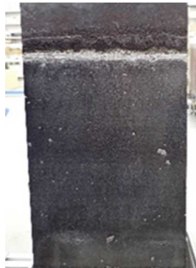
図 4-1-15 電解後カソード表面 (SPCC 材)
