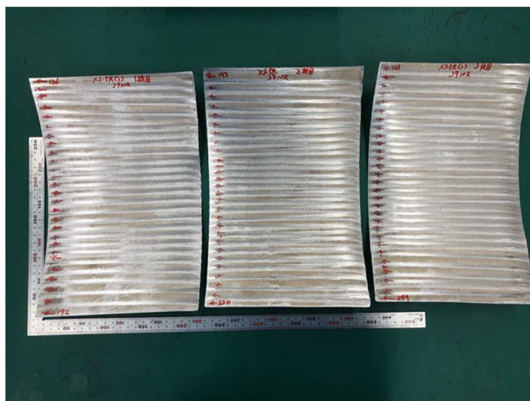
図 4.4.30 DC 鋳造したベース合金の IF-HPS 材の外観(加工条件:3mm-5R)
