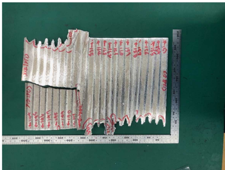
図 4.4.29 DC 鋳造したベース合金の IF-HPS 材の外観(加工条件:15mm-1P)
