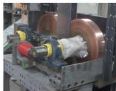
図 4.4.7 縦型双ロール鑄造機 (板幅 50mm)
