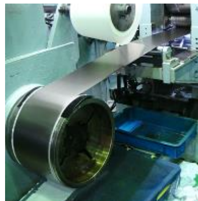
図 3-2.3.2-a6 冷間圧延の状況
