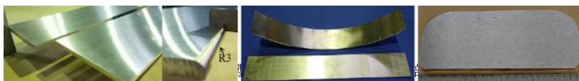
図 3-2.5.7-101 作製した気密疲労試験構体部材
