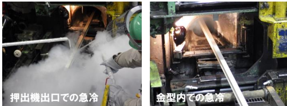
図 3-2.5.7-92 液体窒素冷却によるドアビーム型材の実機押出の状況
