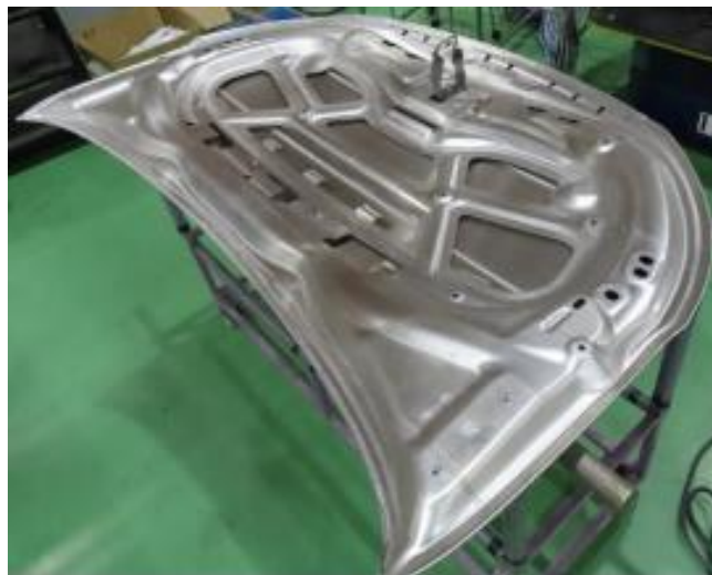
図 3-2.5.7-56 ローラヘミング加工後のフードアッシー成形品（インナー側）
