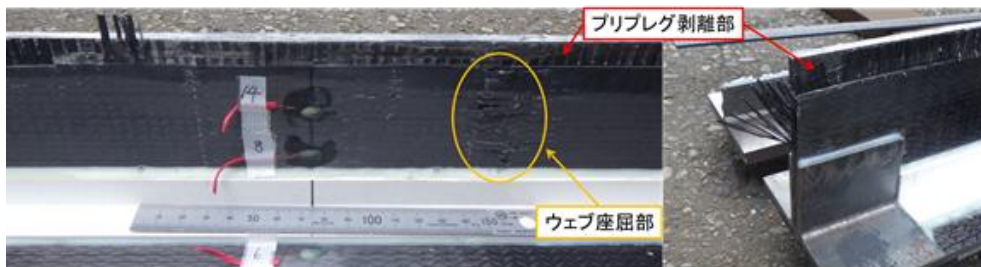
図 3-2.2.7-9 試験後の構造破壊状況
