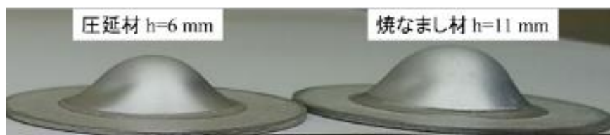
図 3-2.5.7-104 希薄合金のパンチ速度 60 mm/min における室温張出し試験片外観
