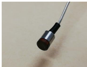
図 3-2.2.12-34 試作 φ3mm-10MHz 探触子
