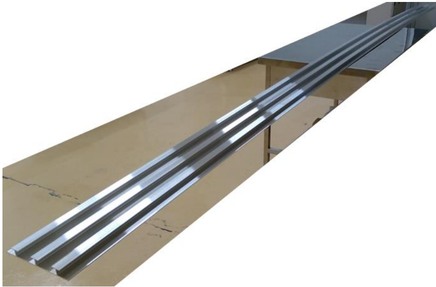
図 3-2.5.7-119 AX92 合金の床材 (長さ 5.5m)
