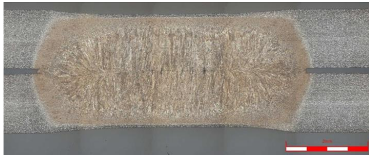
図 3-2.2.12-88 従来溶接機による抵抗スポット溶接部断面
