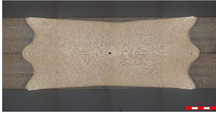
図 3-2.2.12-87 高速インバータを電源とした抵抗スポット溶接部断面の例(25kA-10ms)
