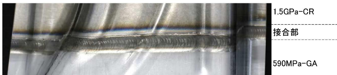
図3-2.2.4-24 最終プレス後サンプルの接合部外観
