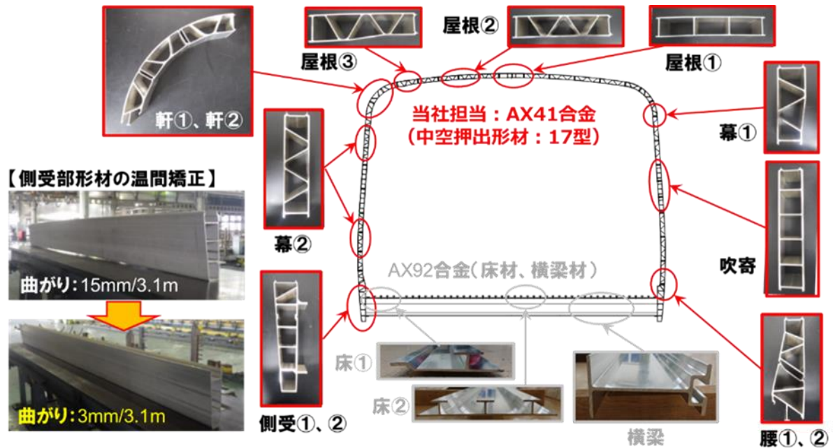
図 3-2.5.7-89 試作した気密モックアップ構体用 AX41 合金大型押出中空型材の概要
