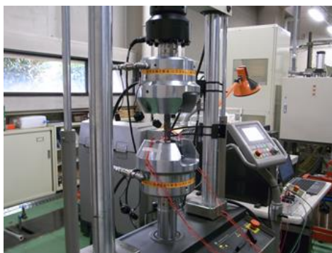
図 3-2.2.7-10 疲労試験状況
