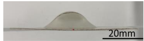
図 3-2.5.7-129 室温エリクセン試験結果
