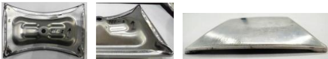
図 3-2.5.7-47 製作した小型フロントフード
