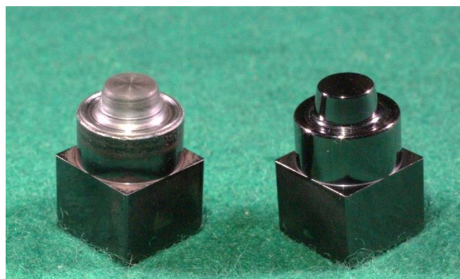
図 3-2.2.6-7 ツール写真（左：1万打点後、右：新品）
