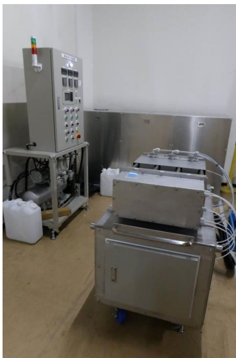
図 3-2.2.14-3 室温・大気中における腐食疲労試験機の外観写真
