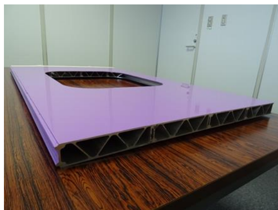
図 3-2.5.2-14 AX41 合金ダブルスキン形材で試作した部分側パネル構体の外観
