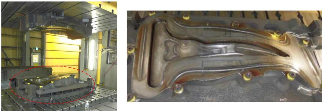
図3-2.2.4-21 Bピラーモデル作製のプレス金型例
