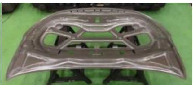
図 3-2.5.7-53 製作したインナーパネル (レーザー加工後)
