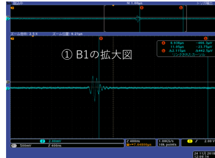
図 3-2.2.12-33 適用周波数と計測分解能 (5MHz,10MHz 探触子)
