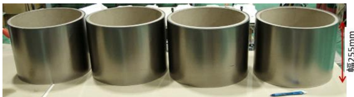
図 3-2.3.2-a7 得られたチタン薄板（開発材）コイルの外観
