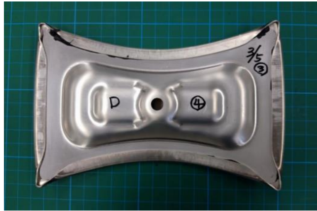
図 3-2.5.7.132 小型フード(インナ/ア ウタ、ヘム)形状の成形テスト (インナ・ア ウタ成形品のヘム加工成形体外観)
