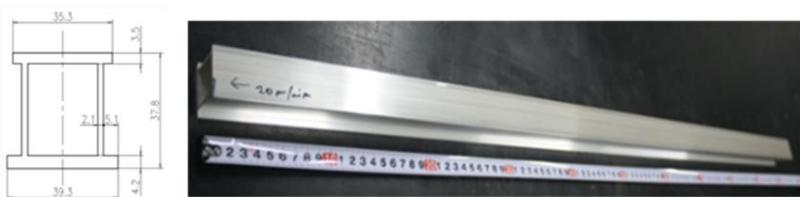
図 3-2.5.7-90 試作した AXM10207 合金ドアビーム型材
