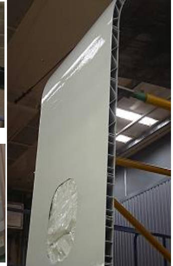
図 3-2.5.5-9 モデル構体への化成処理と塗装
