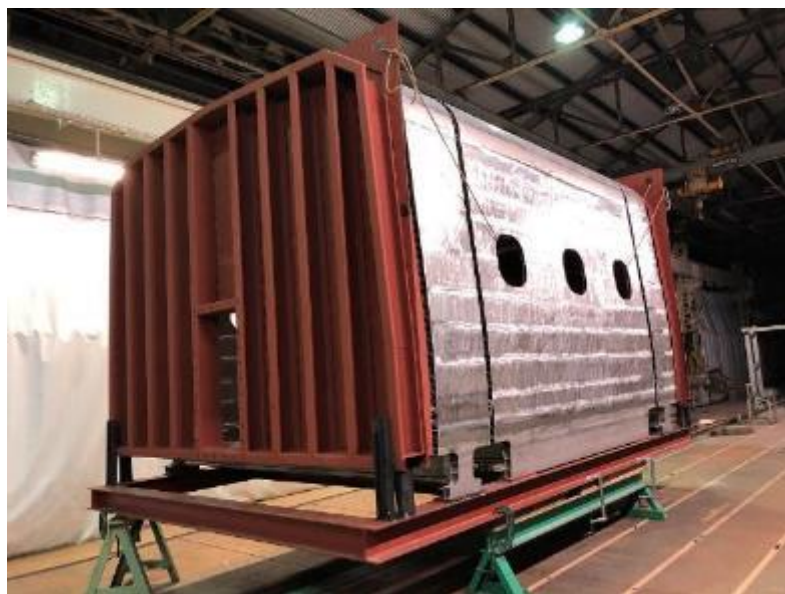
図 3-2.5.7-6 気密疲労試験用 6 面体構体
