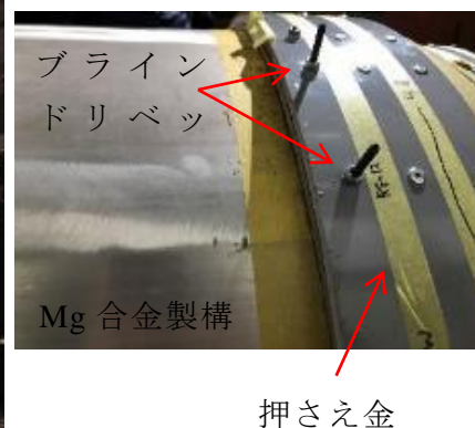
図 3-2.5.7-7 構体接続部の拡大図
