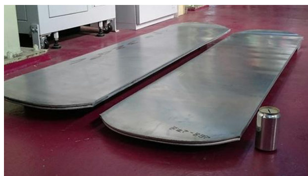
図 3-2.4.1.2-4-2 最適な熱間圧延条件で作製した革新 7000 系合金板材
