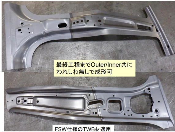
図 3-2.1.2-30 FSW で製造した TWB 製 B ピラー
