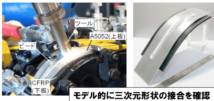
図 3-2.2.1-11 ロボット設備を用いた FLJ モデル検討
