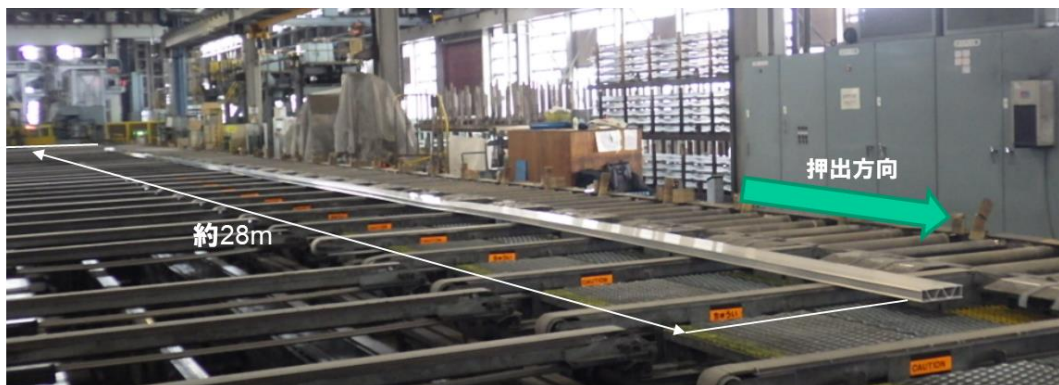
図 3-2.5.7-91 大型・長尺ダブルスキン型材の押出成形実験の状況
