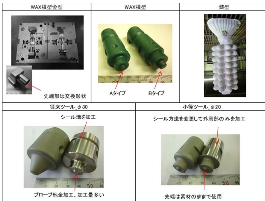
図3-2.2.8.B-48 精密鋳造品の製造工程及びツール形状比較
