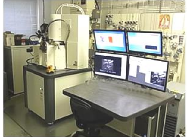
図 3-2.6.2-6 開発されたその場装置の外観（制御部）
