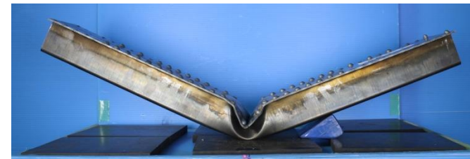
(c) アークスポット 5.8\sqrt{t}+20\text{mm} ピッチ
