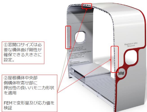
図 3-2.5.1-19 簡易モックアップの構造的特徴
