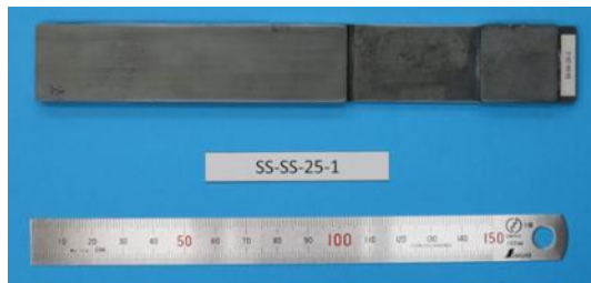
(a) 鋼材どうしの接着継手
