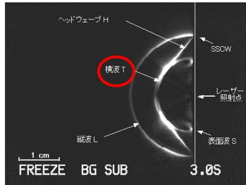
図 3-2.2.12-31 レーザー超音波の送信音場可視化画像
