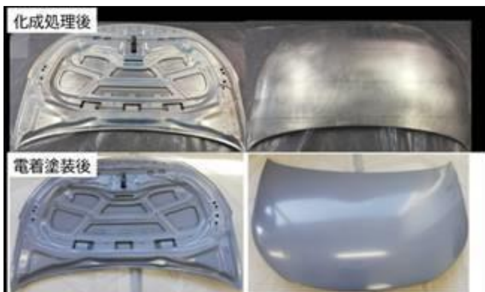
図 3-2.5.7-67 化成及び電着塗装後の外観
