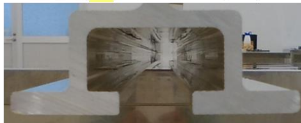
図 3-2.5.7-120 AX92 合金の横梁試験押出材 (長さ 3.3m)
