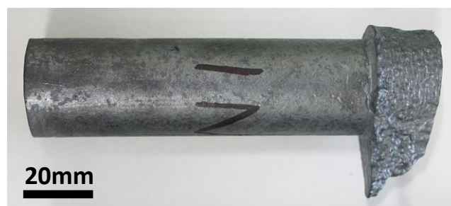
図 3-2.2.8.A-23 試作した Co 基合金インゴット
