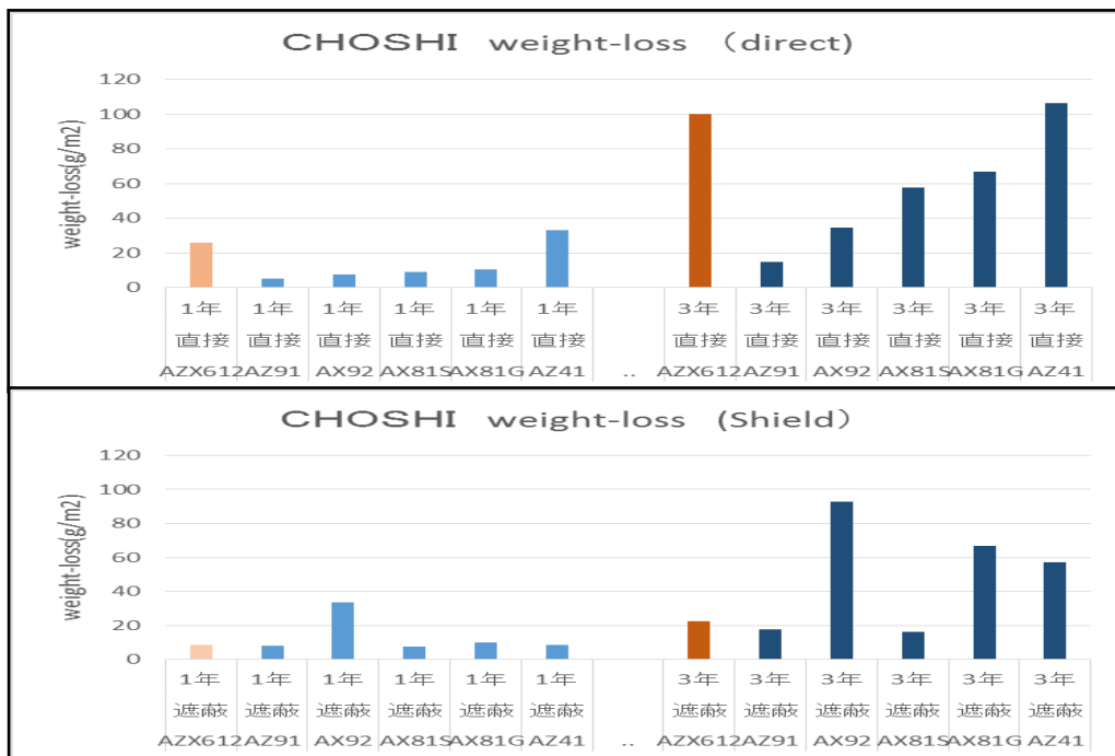
図 3-2.5.7-42 腐食減量の評価（銚子）上図：直接暴露、下図：遮蔽暴露
