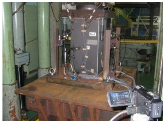
図 3-2.2.7-16 複合柱構造体載荷試験
