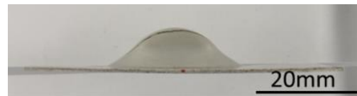
図 3-2.5.7-135 室温エリクセン試験結果
