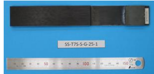
(b) 鋼材と/熱可塑性樹脂 CFRP の異材継手
