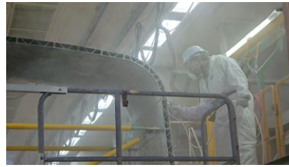
図 3-2.5.5-9 モデル構体への化成処理と塗装
