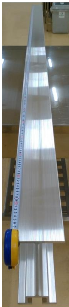
図 3-2.5.7-120 AX92 合金の横梁試験押出材 (長さ 3.3m)
