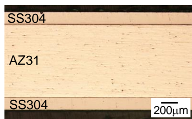
図 3-2.6.4-4 鋼/Mg 合金の複層化
