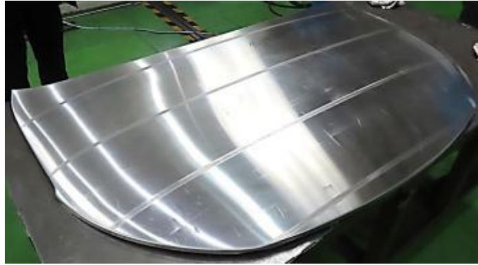
図 3-2.5.7-54 開発合金による 1/1 アウターパネルプレス成形品
