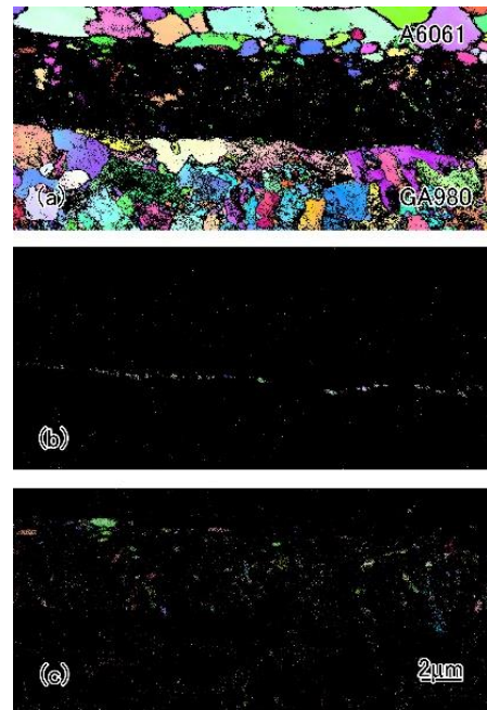
図 3-2.2.13-38 (a) 980GA/A6061 の方位マップ (b) \text{Fe}_2\text{Al}_5 (c) \text{FeAl}_3 の分布
