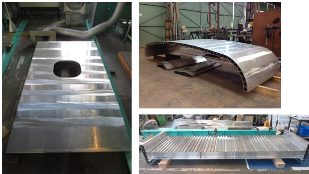
図 3-2.5.2-16 接合後の簡易モックアップ構体の外観 (左・側パネル、右上・屋根パネル、右下・台枠；横浜金沢分室提供)
