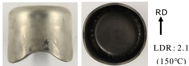
図 3-2.5.7-136 温間深絞り試験結果
