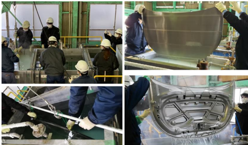
図 3-2.5.7-66 1/1 フロントフード処理の様子
