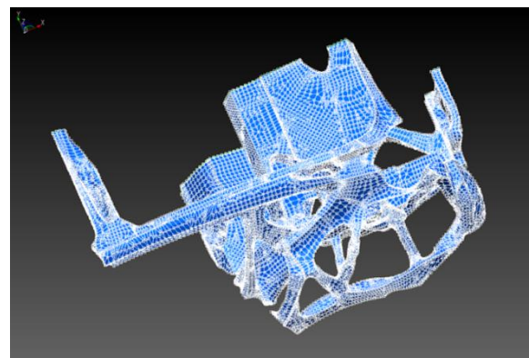
図 3-2.1.1-67 自動サーフェス生成例 (spScan)
