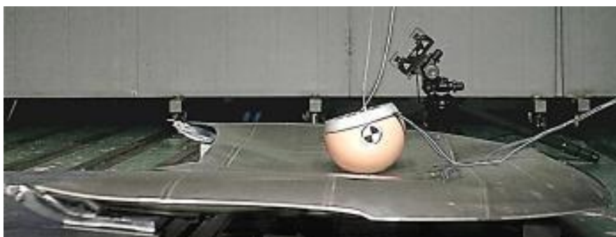
図 3-2.5.7-57 頭部歩行者保護性能試験時の開発合金によるフロントフードの状況
