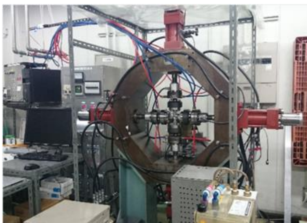
図 3-2.5.7-15 試験装置外観 (2軸疲労試験)
