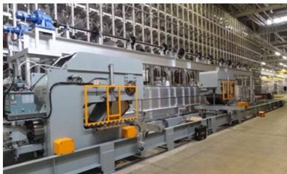
図 3-2.5.2-17 Mg 専用大型・長尺型材温間ストレッチ矯正装置の概要
