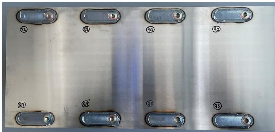
図 3-2.2.8.B-15 2021 年度作製プレス成形部材アッセンブリ接合試作品
