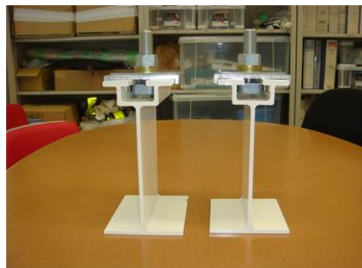
図 3-2.5.1-20 床下機器吊供試体
