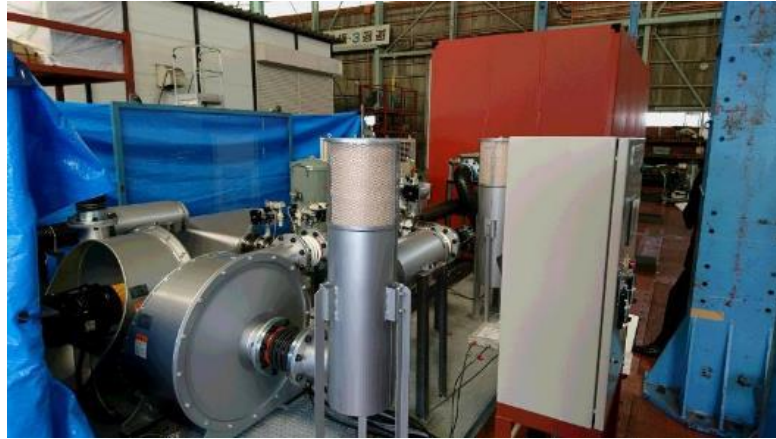
図 3-2.5.7-19 模擬構体による気密荷重試験
