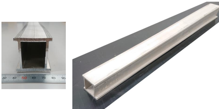
図 3-2.5.7.125 押出加工によって作製したドアビーム型材 (左) 型材断面外観、(右) 型材外観
