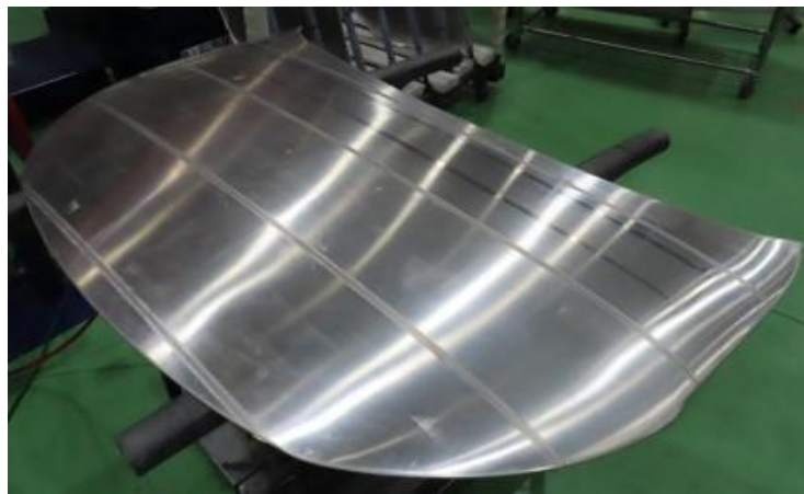
図 3-2.5.7-55 ローラヘミング加工後のフードアッシー成形品（アウター側）
