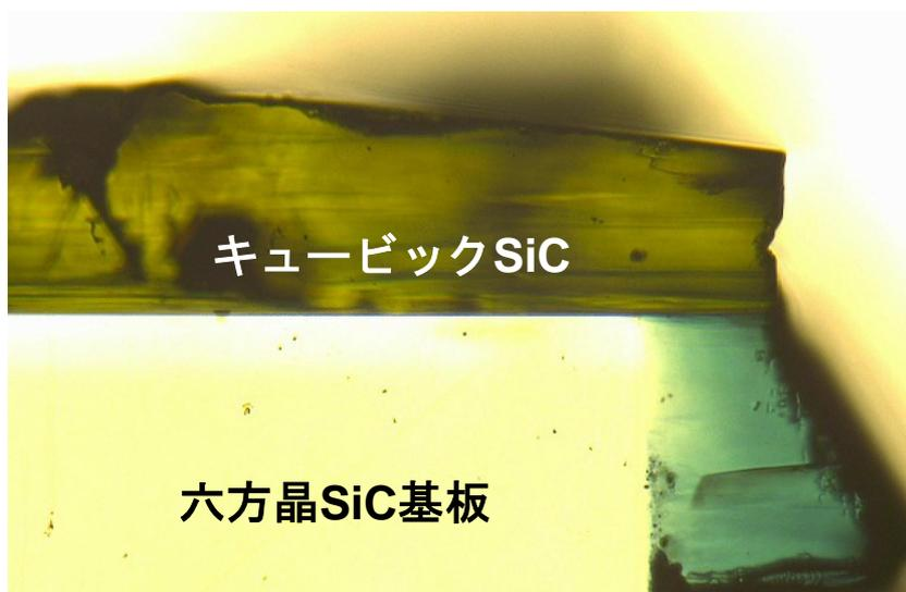
図2: 結晶の断面写真。六方晶構造を持つ SiC 上にキュービック SiC が安定に成長している。
