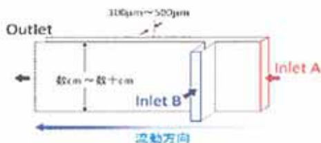
図1 深溝型マイクロリアクタの概念図(左)とパイロットプラント(右)
