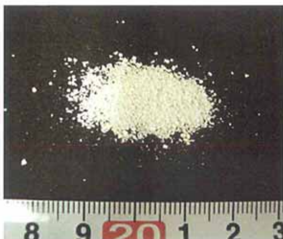
図1 今回開発した高密度化学蓄熱材(金属塩添加水酸化マグネシウム)の外観 表面を化学的に修飾することにより、蓄熱操作温度の低下を実現
