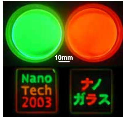
図5 . ソルゲル法で作製したテルル化カドミウム超微粒子分散ガラスの発光 〔下の模様はガラス基板に流しこみ固めて作製したものである〕
