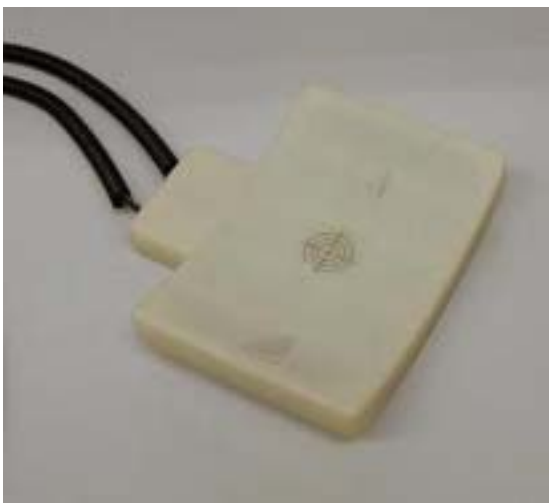
図 1. 1H / 13C ダブルチューンコイル . 1H は 128.91 MHz に、13C は 32.165 MHz にそれぞれ調整されている .
