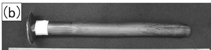
図③-30 直径  $22\ \text{mm}$  の押出成形体
