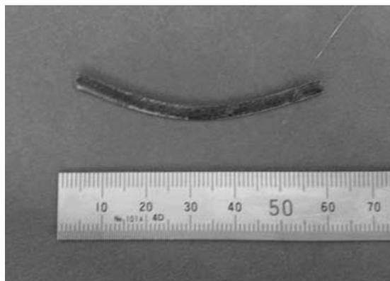
図③-50 Pd 基金属ガラス箔 + 純 Cu 箔で作製したクラッド材
