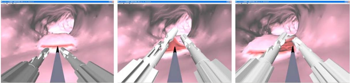
図 51 胃内の粘膜層をロボットアームとニードルメスの連携動作により把持しながら切開している状況
