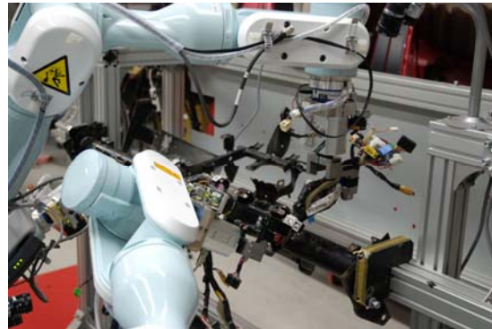
図5. 片手でワイヤーを整形しながら、他の手で取る付けを行う
