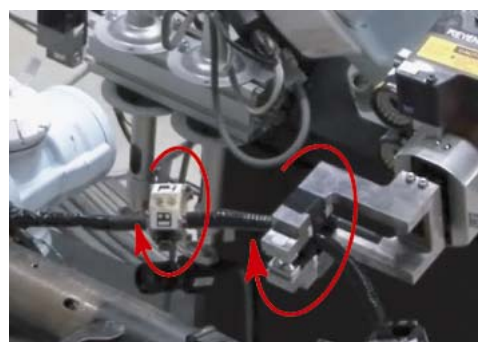
図3. ワイヤーのねじれ状態を制御
