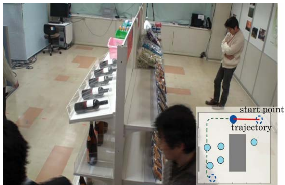
(b) ロボット移動中に予定経路上に複数の人が現れた事をグローバル情報 (環境カメラ) から受け取る
