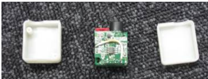
図 9. 加速度センサ付き超音波タグ
