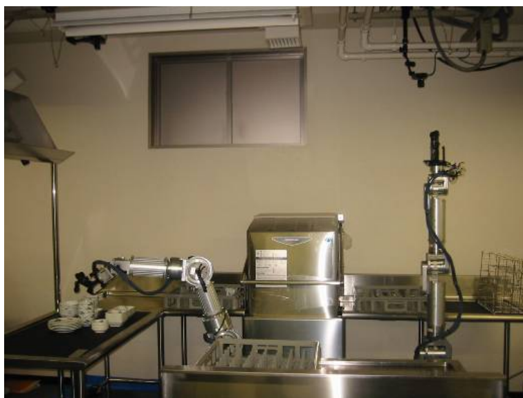
図5 食器ハンドリングのためのロボット統合制御実験
