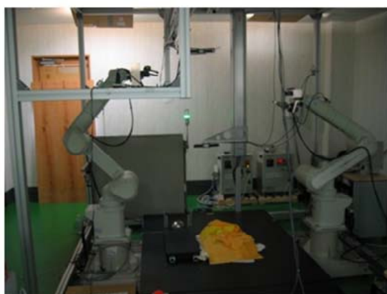
図 2.1-5 全体視覚センサとロボットが協調した最上位布取り出し
