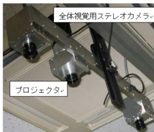
図 2.1-5 全体視覚センサとロボットが協調した最上位布取り出し
