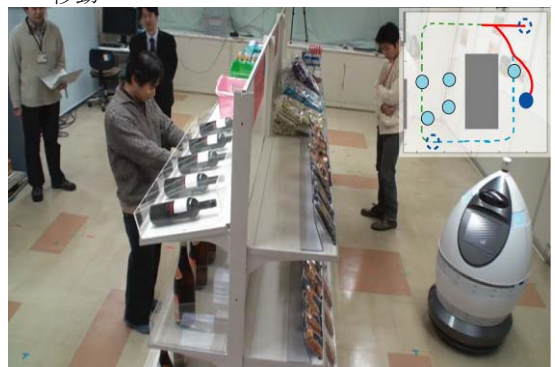
(d) 近距離の物体に対してはローカル情報を用いて回避
