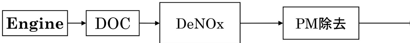
2. 熱回収装置＋SCR触媒（産総研）＋プラズマPM除去(ダイハツ・RITE)
