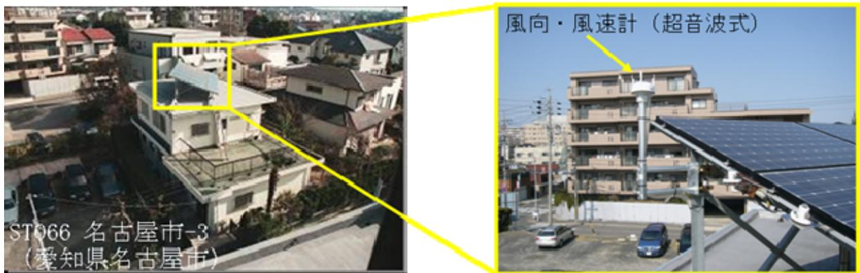
図 2.2.2-8 風向・風速計の設置
