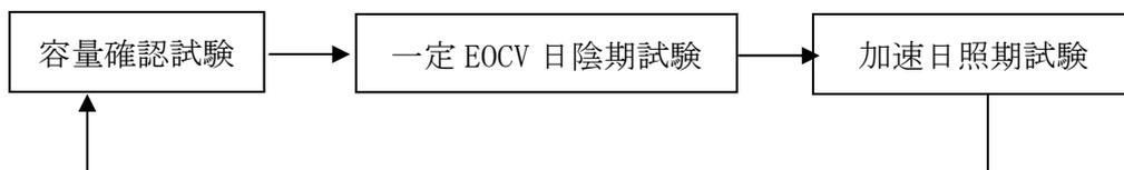
図 3.2.12.1-4 一定 EOCV 静止軌道衛星模擬試験フロー
