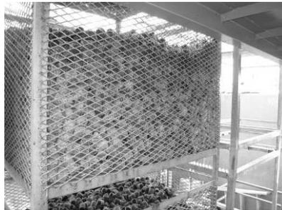
図 2. 2. 1-2 カゴ状カートリッジに充填されたキューブ型担体
